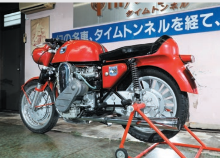
巨大なアルミ製の燃料タンク下に、直立したアウトユニオンNSU製1177ccエンジンを搭載する。キャブはウェーバー製で、インジェクション仕様が併売される前のキャブ最終型は激レアだ。
