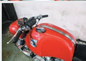
巨大なアルミ製の燃料タンク下に、直立したアウトユニオンNSU製1177ccエンジンを搭載する。キャブはウェーバー製で、インジェクション仕様が併売される前のキャブ最終型は激レアだ。
